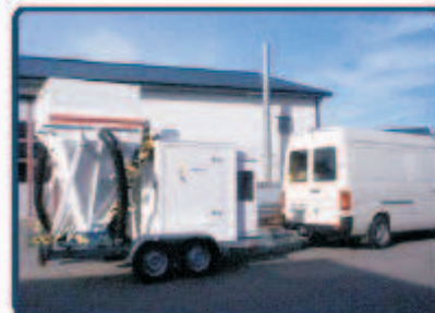
Urządzenie ssące SDW-3,5T może być przewożony drogami publicznymi na przyczepie o nośności 3,5t.
