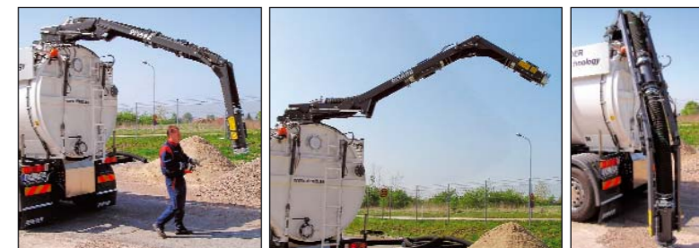
Wysięgnik zwiększa zasięg urządzenia i ułatwia operowanie węzłem
