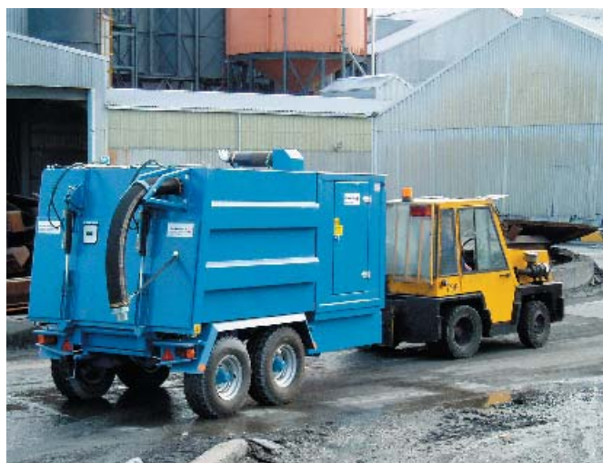
Huta aluminium. Mobilny agregat próżniowy SET-10T napędzany silnikiem „diesla”.
